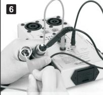
探测线的应用:将两条配送的探测线插入红黑两个插 孔内,如果探测笔两段直接接通会出现"滴滴"的蜂 鸣声并且黄色LED亮起,使用此方法可以检测在测线 器上没有对应插孔的音频线,用探测笔连接对应线材 端口,如出现整鸣声表示线材连通。
