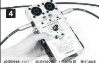
检测线材(一):将旋钮拧到"1"的位置,黄灯和绿灯同时亮起,表示此线的"PIN 1"连接没有问题。
