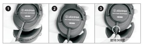
将插头插进耳机孔然后旋转360度。
