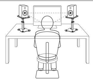
将两个音箱与听音位置成一个正三角形,两个音箱的内射角度要30-45度。
