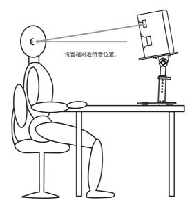
$\pm 10^\circ$ 的倾斜角度(可调角度 - $10^\circ$ ,- $5^\circ$ ,- $3^\circ$ , $0^\circ$ , $3^\circ$ , $5^\circ$ , $10^\circ$ )。根据您自己的身高和支架的高度,您可以按照以上的规则来调节音箱的角度和高度。
