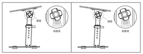
将旋钮拧松您可以调节角度(可调角度 -10°,-5°,-3°,0°,3°,5°,10°), $\pm$ 10°的倾斜角度,可以使您将音箱位于您理想的角度。
